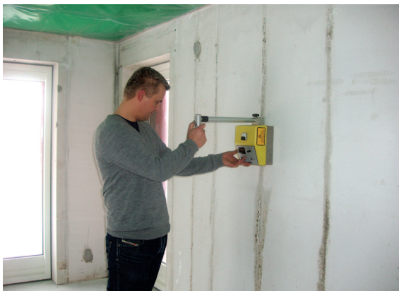
Der findes forskellige målemetoder at aflæse fugten i væggene. Jørgen Nymark Klavsen har arbejdet længe med at overføre troxlerens tællelæs til procent. Troxleren måler fugt ti centimeter inde i væggen og er derfor mere sikker at bruge end andre måleapparater.
